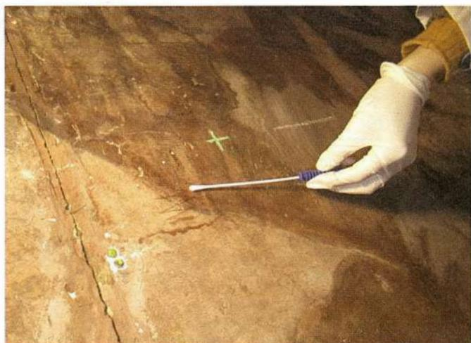
Figura 6. Test per medir si hi ha presència dels bacteris després del procés de neteja.
